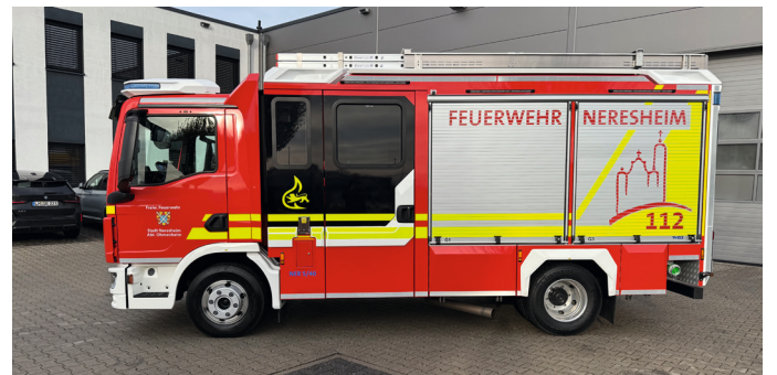
Das wasserführende MLF, in dem insgesamt sechs Feuerwehrkameraden Platz haben, hat einen Tank für 1.000 Liter. Viele technische Finessen, darunter eine Rückfahrkamera, eine 360-Grad-Kamera, ein Einsatznavi und ein „normales“ Navi ergänzen die Fahrzeug- und Einsatztechnik
